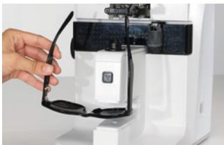
Analice exhaustivamente las propiedades de protección de UV de la lente midiendo simultáneamente la transmisión UV con cuatro longitudes de onda diferentes entre 365-405 nm.
