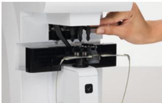
El VISULENS 500 de ZEISS proporciona un soporte para lentes de 4 puntos para el montaje seguro y fiable de cualquier tipo de lente. Un sistema preciso tipo lápiz garantiza un funcionamiento sencillo y un marcado claro del centro óptico y el eje del cilindro.
